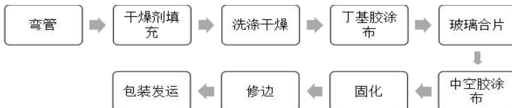
图 3-4 中空玻璃生产工艺流程图
