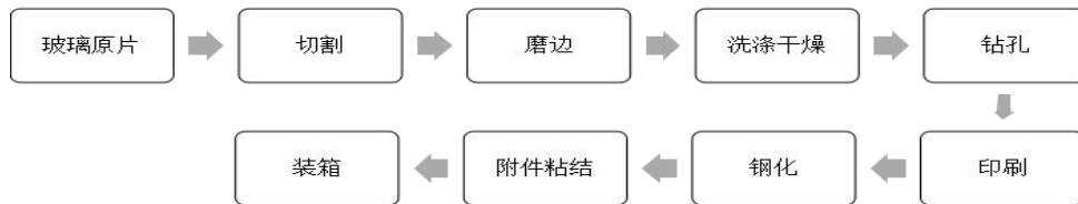
图 3-2 钢化玻璃生产工艺流程图
