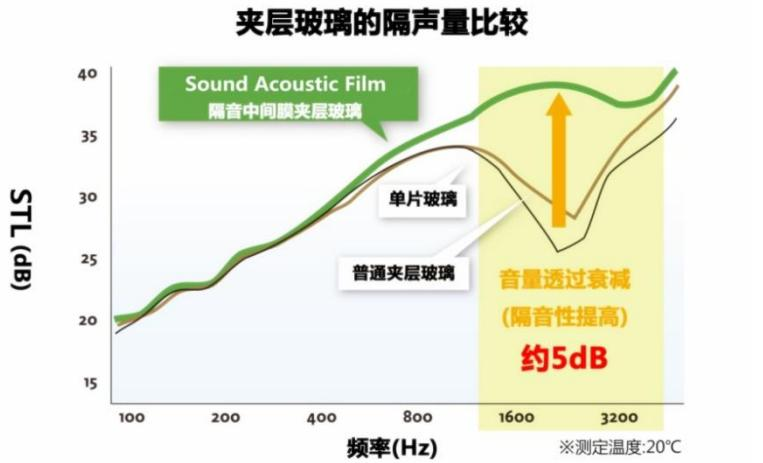
音量透过衰减越大，隔音性能越高
