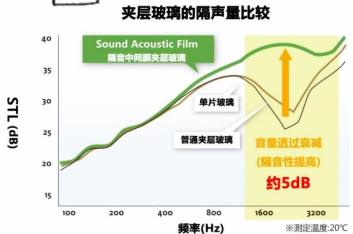
音量透过衰减越大，隔音性能越高
